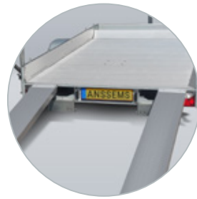
Aluminium Auffahrampen und integrierte Rampenhalter
