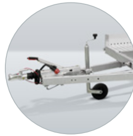
Lange Deichsel aus Rechteckrohrprofil
