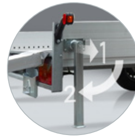
Einfach zu drehende Abstellstützen
