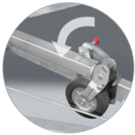
Klappbares Stützrad ermöglicht Weiterfahrt (siehe Tabelle)
